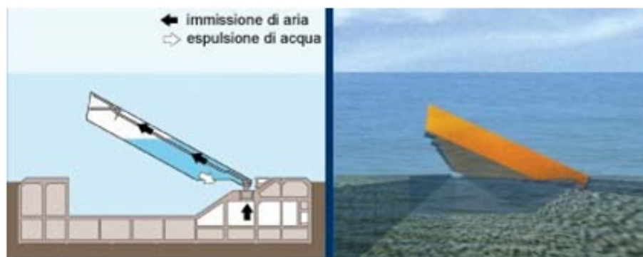
Figura 2.1 – Fase di sollevamento delle paratoie.
