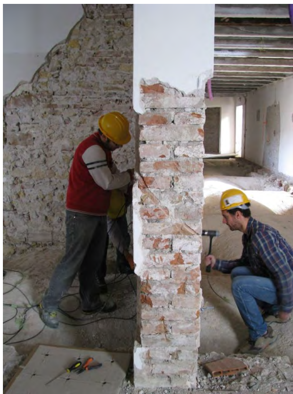
Figura 3.6. 2 - foto esecuzione tomografia sonora
