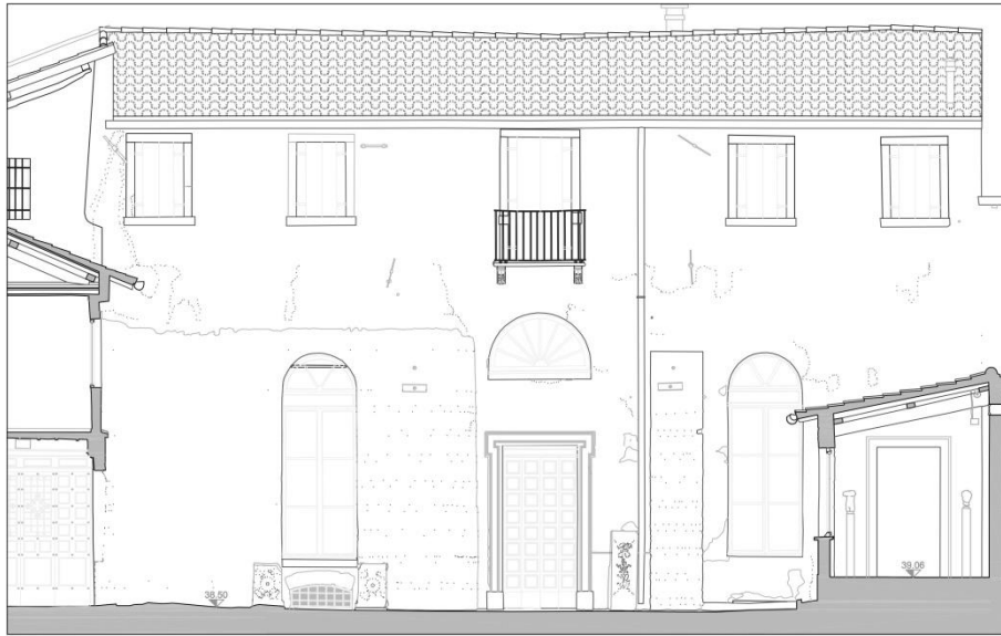
Figura 5.4. 7 - quadro fessurativo facciata sud refettorio
