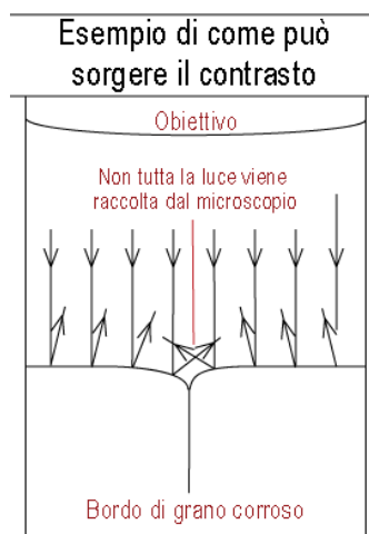
Figura 2.10: Effetto dell'attacco chimico sulla riflessione della luce. Fonte: [57]
