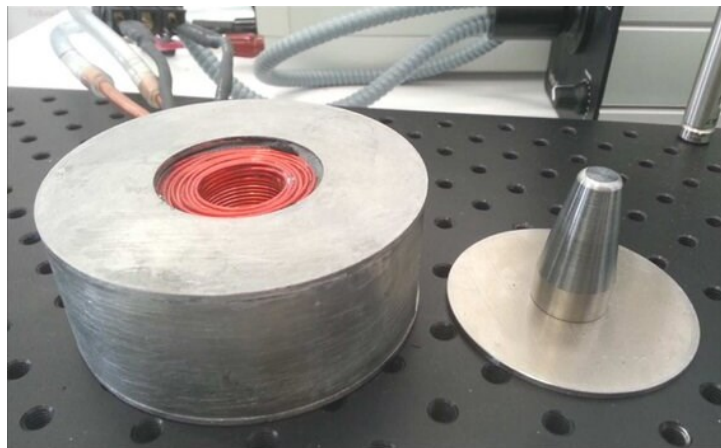
Figura 1.8: Fotografia che mostra la bobina circondata da un alloggiamento in ferro puro (a sinistra) e il nucleo di ferro conico che può essere inserito al centro per migliorare il campo magnetico generato (a destra). Fonte: [63]
