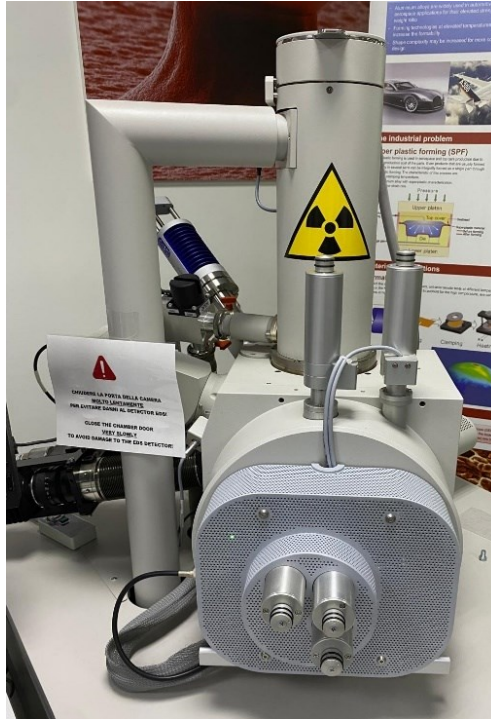
Figura 2.9: SEM FEI Quanta 450. All'interno della colonna verticale viene generato e direzionato il fascio elettronico. La parte frontale si apre a scorrimento e permette di accedere all'interno della camera per posizionare i campioni.
