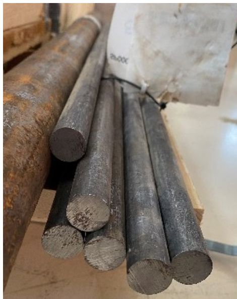
Figura 2.1: Barre per la realizzazione dei campioni da tornire.
