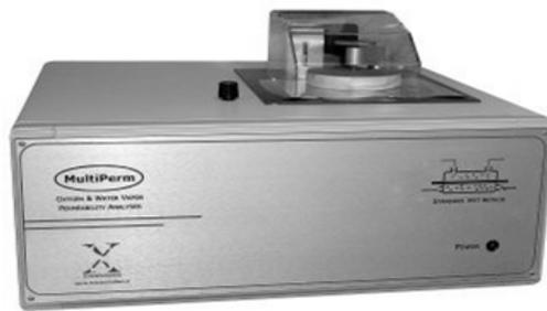
**Figura 4.18.** *Permeabilmetro usato per i test*
