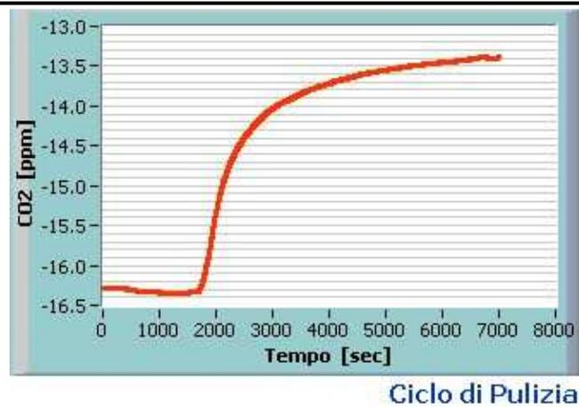
**Figura 6.1.** Andamento dei ppm di CO<sub>2</sub> durante la fase di condizionamento
