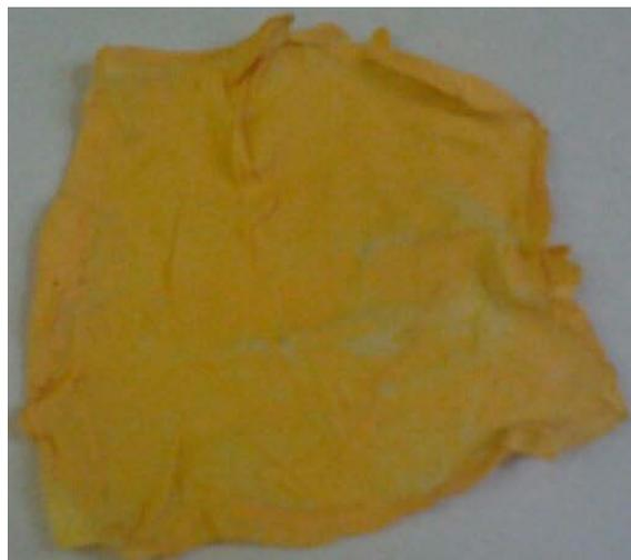
**Figura 5.4.** Membrana ottenuta conducendo la reazione di funzionalizzazione sulla membrana di PAN a 110°C per 10h.
