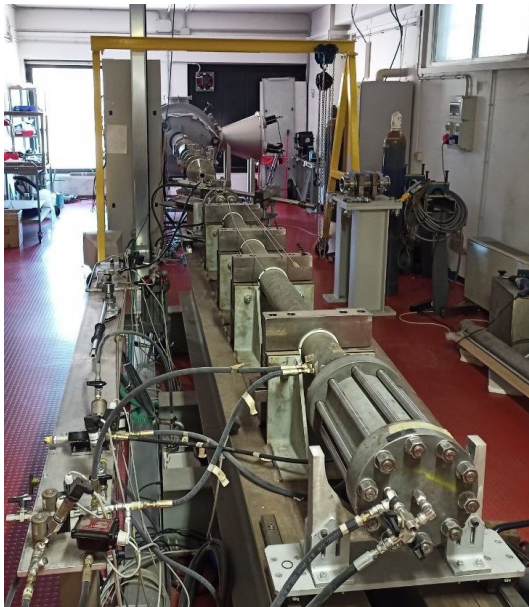
Vista del cannone bi-stadio a gas leggero presente nei laboratori di ipervelocità del CISAS
