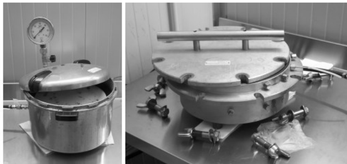
Figura 8. Modelli di camera di Richards (Fonte Vitali, 2019)
