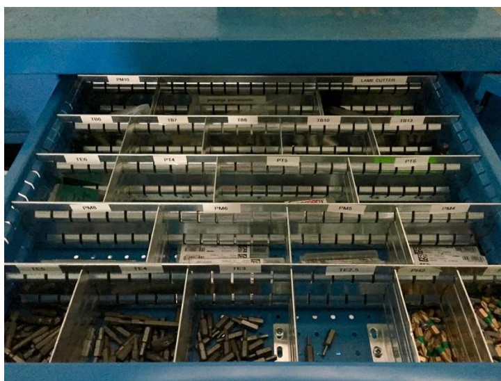
Figura 12. Situazione all'interno del cassetto relativo a punte di trapano e maschi dopo l'applicazione del metodo 5S
