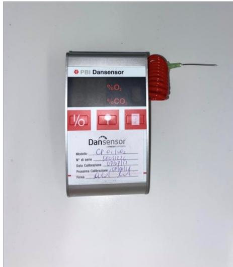
Figura 7: analizzatore di gas portatile PBI Dansensor CheckPoint O<sub>2</sub>/CO<sub>2</sub>
