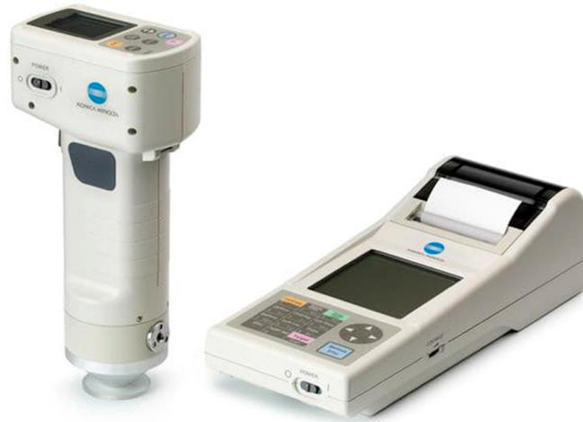
Figura 8: Colorimetro Minolta CR200.
