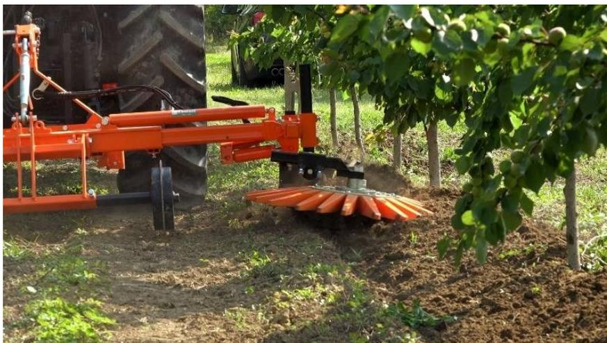
**Figura 4.1:** esempio di diserbo meccanico con l'ausilio di stella orizzontale (Fonte Rinieri s.r.l.).
