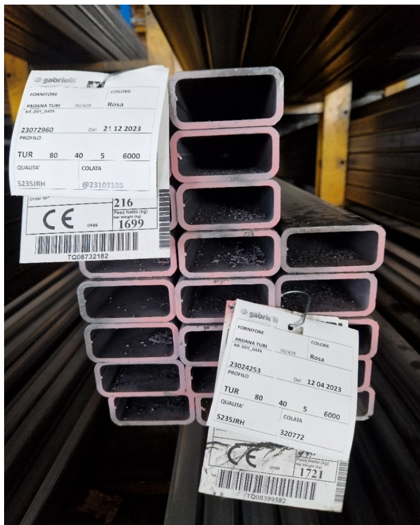
Figura 4.9 - Esempio di due pacchi aperti colorati con la logica attuale
