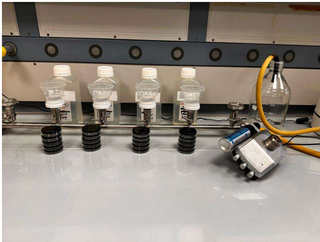
Figura 10: rampa di filtrazione in acciaio inox
