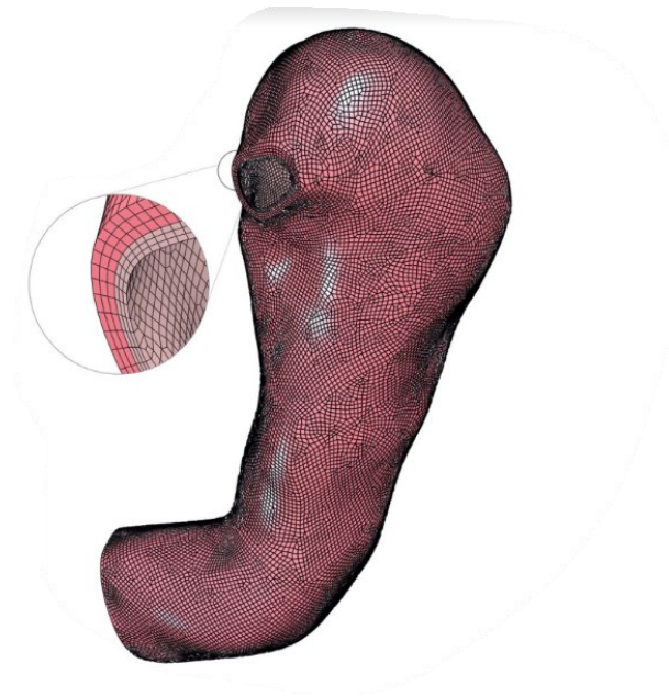
Figura 5.2 rappresentazione dello stomaco con la mesh dove 6 elementi esaedrici formano lo strato della sottomucosa-mucosa e dello strato muscolare
