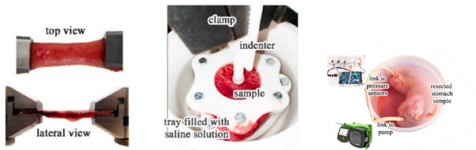
Figura 4.4 a) vengono raffigurate rispettivamente: prova di trazione, prova di indentazione e prova di insufflazione.
