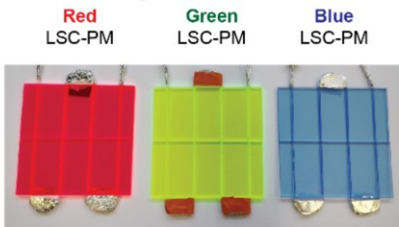
Figura 1: Design reattore LSC-PM. [2]
