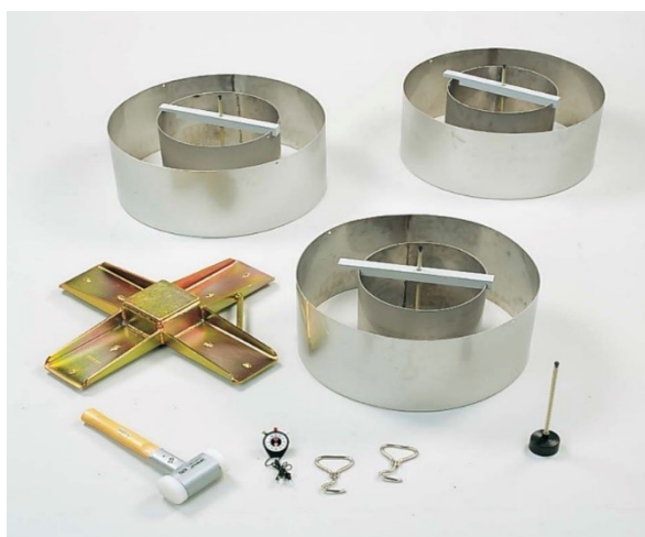
Figura 2.1. set completo test infiltrometrico, tre coppie di anelli con diverse dimensioni, una piastra in acciaio, un martello, quattro strutture asta-galleggiante, tre sostegni in plastica, due ganci per la rimozione e un cronometro
