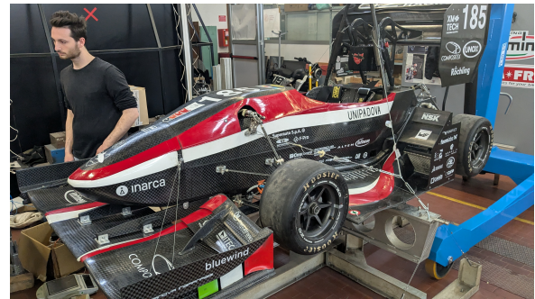
(b) Test per la determinazione dell'inerzia
