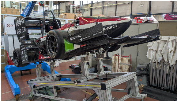
(a) Test per la determinazione del baricentro
