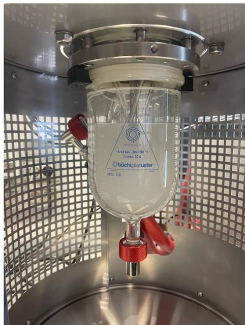
*Figura 5 - Dettaglio del recipiente del reattore contenente la soluzione in analisi*
