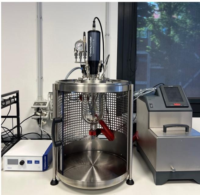
*Figura 4 - Reattore, termostato e agitatore*
