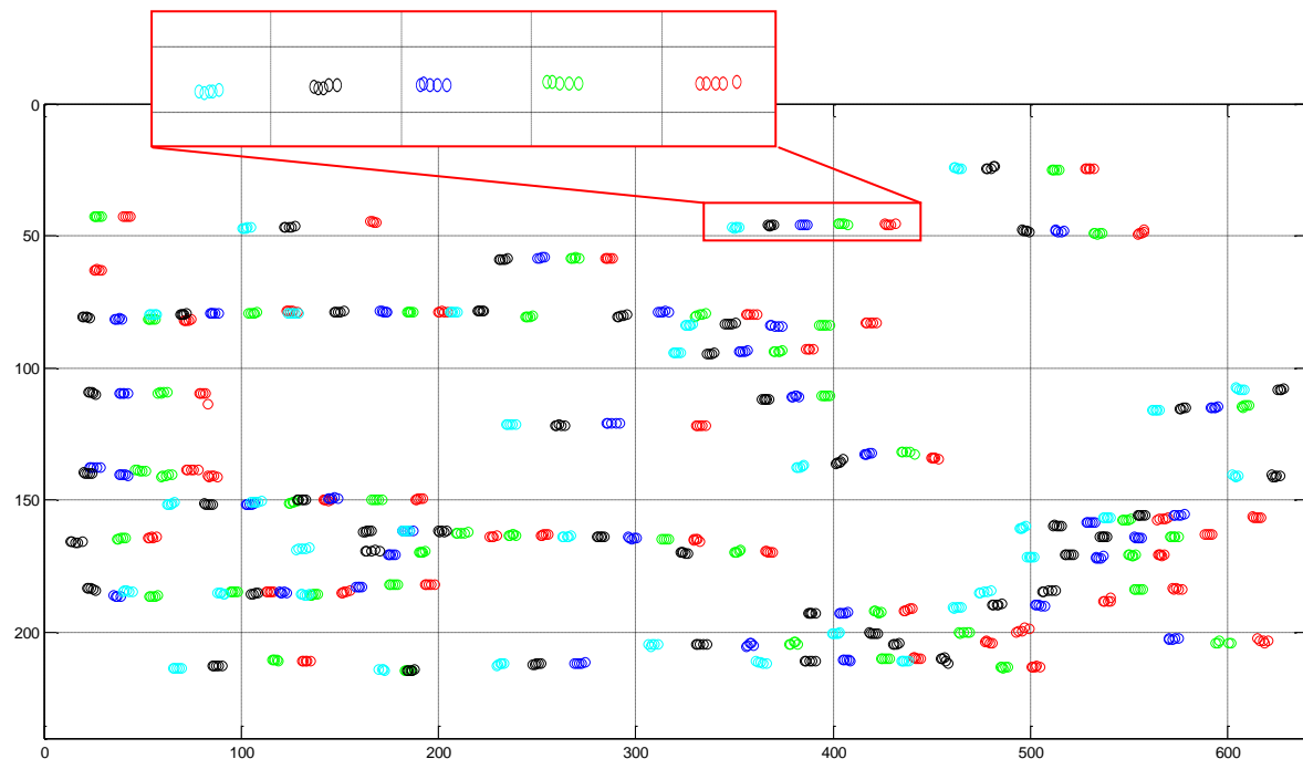
Figura 3.8 Particle tracking: ogni punto corrisponde alla posizione di una bead in un frame nel canale microfluidico. Sono analizzati 5 frame alla volta per 25 frame totali. I gruppi di frame sono evidenziati in sequenza dai colori azzurro, nero, blu, verde, rosso rispettivamente (nel rettangolo rosso il cammino completo di una bead nel tempo)
