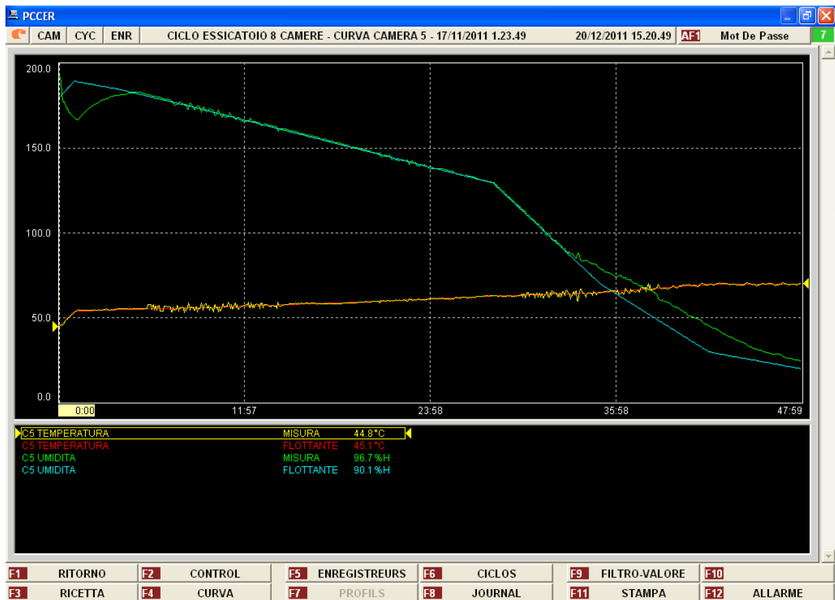
Figura 8 Curva essiccatoio SML per un ciclo a 48h
