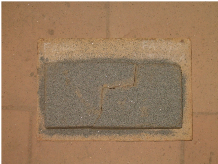
Figura 9 Rottura per essiccazione troppo rapida
