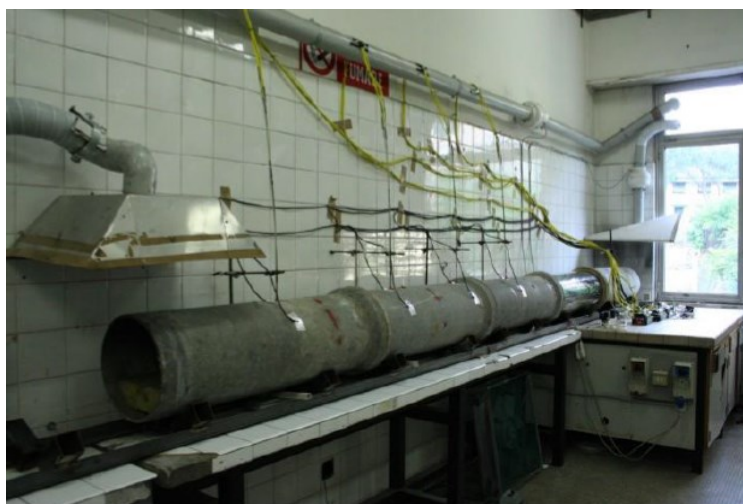
Figura 4.1 Riproduzione in scala della galleria “Brasile”.
