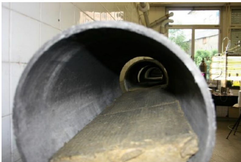
Figura 4.2: Dettaglio longitudinale della riproduzione in scala della galleria "Brasile".
