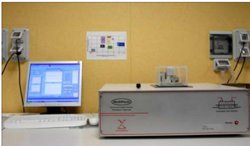
Figura 15 - MultiPerm di ExtraSolution per misure di permeabilità a  $CO_2$  di film sottili
