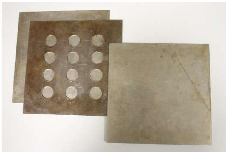
*fig. 12 – piastre e maschera per provini per il reometro*
