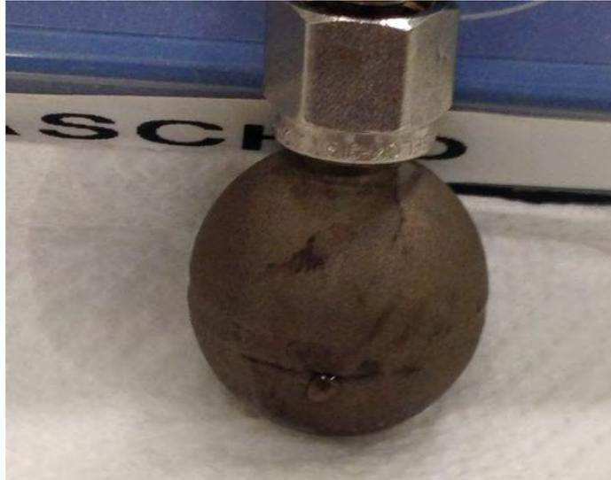
**Figura 3.8** Cella in acciaio AISI 316L forata dalla miscela  $H_2O_2 - HCOOH$
