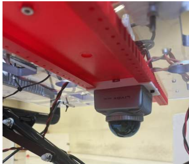
Figura 4.5: Lidar montato sulla guida
