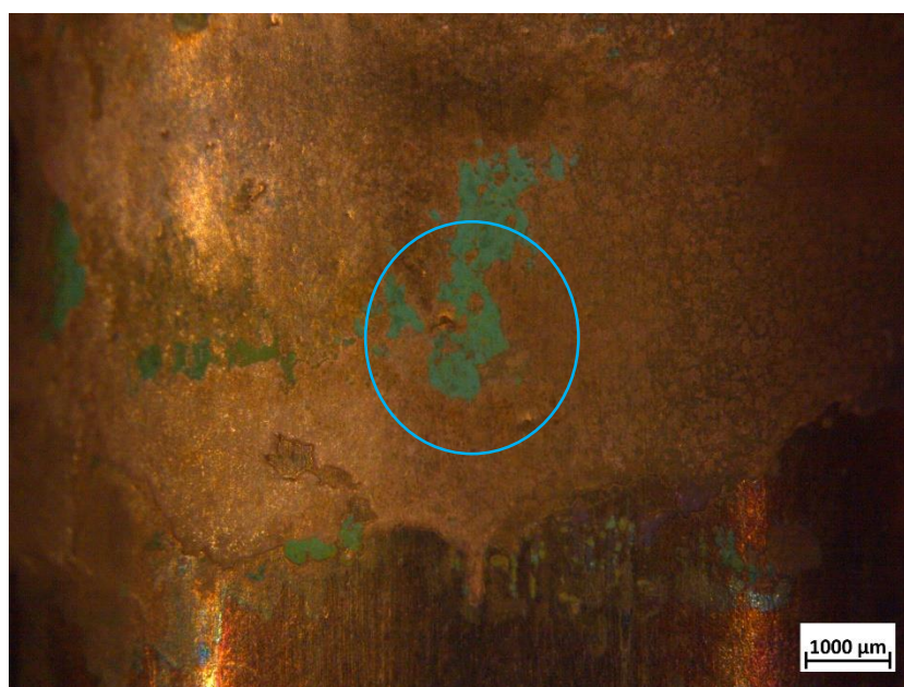
Figura 4.14 - Formazione di pit tipo II su provino sottoposto a prova di polarizzazione potenziodinamica come fornito a T = 80 °C in soluzione 3% NaCl e pH non corretto.
