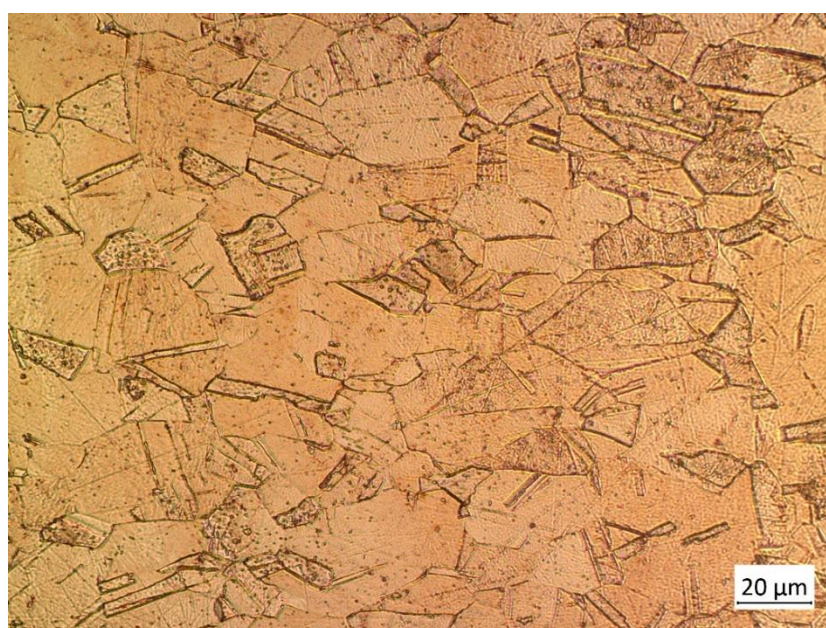
Figura 2.36 – Dettaglio della microstruttura della sezione ortogonale del tubo, zona interna non deformata.
