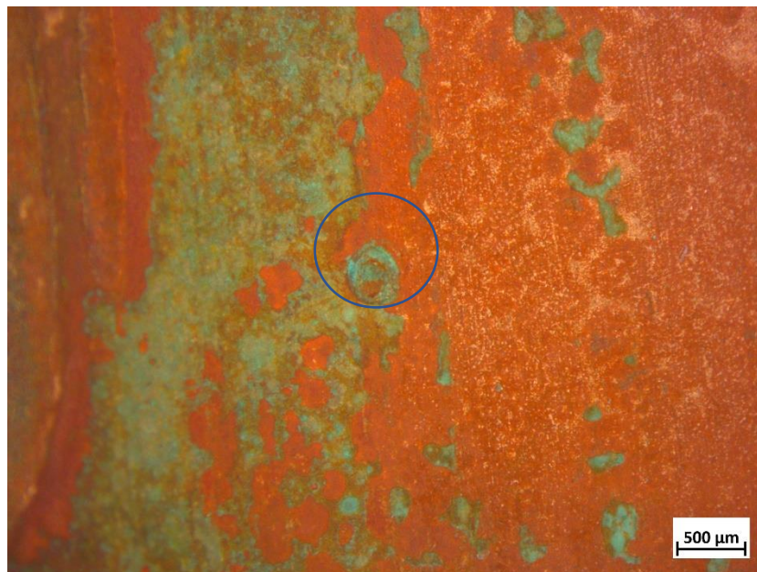
Figura 4.13 – Formazione di pit tipo I su provino sottoposto a prova di polarizzazione potenziodinamica come fornito a T = T_{amb} , in soluzione 1,5% NaCl e pH non corretto.
