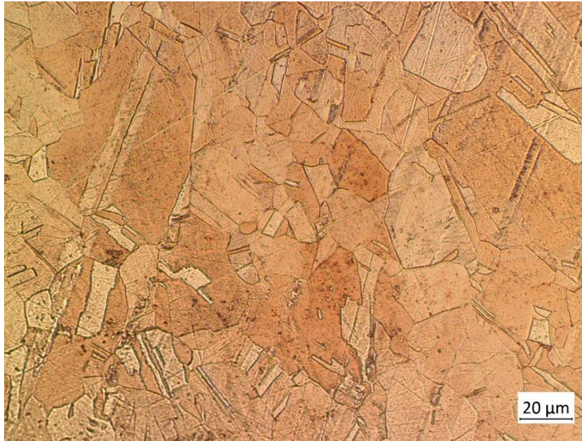
Figura 2.37 – Dettaglio della microstruttura della sezione longitudinale, lato interno, del tubo.
