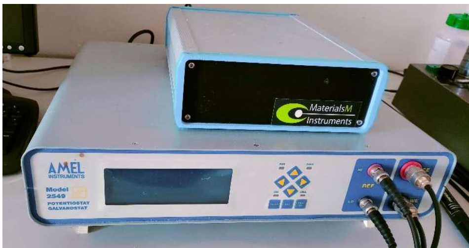
Figura 23 Configurazione test di corrosione e potenziostato AMEL
