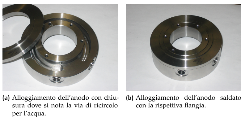
Figura 21: Alloggiamento dei coni prima e dopo la saldatura.
