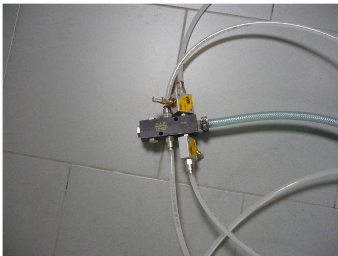
Figura 27: Particolare del rubinetto di ingresso. Il tubo tigrato entra nel ripartitore idraulico che divide il flusso d'acqua in quattro. I due rubinetti sono messi per poter meglio gestire il flusso di acqua entrante nel catodo.
