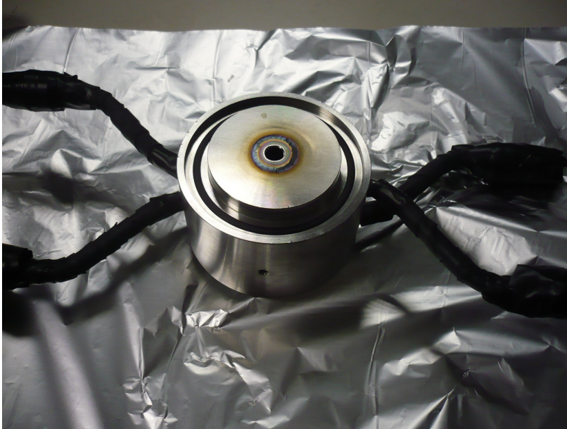
Figura 18: Catodo con i quattro tubi per il raffreddamento saldati e avvolti col nastro isolante. Si possono notare la saldatura attorno al cilindro centrale, l'o-ring per tenere il vuoto con il vetrino in pyrex e il foro filettato per l'attacco dell'alimentazione.
