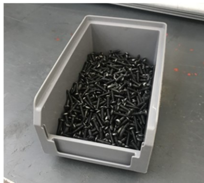
Figura 5.10 Viteria nella nuova unità di carico
