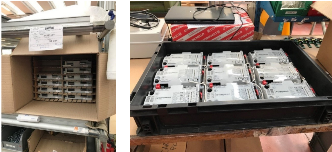
Figura 5.1 Situazione AS-IS (scatolone) e TO-BE (cassetta)
