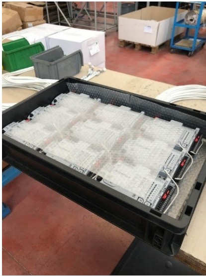
Figura 5.2 Schede nelle cassette D e prove di impilaggio
