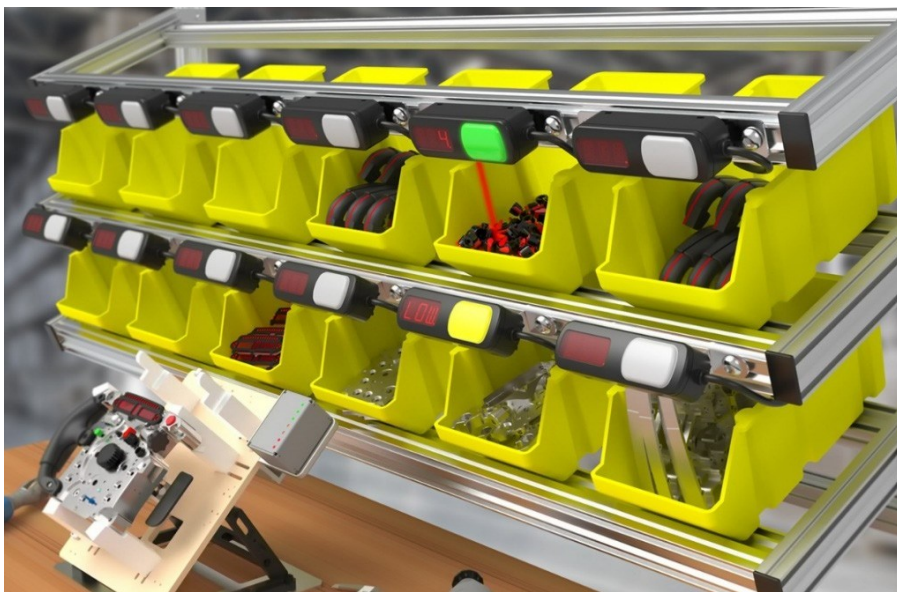
Figura 5.27 Applicazione pick-to-light nell'assemblaggio [22].
