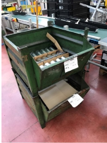
Figura 3.4 Motori 24V posizionati di fianco alla postazione della linea
