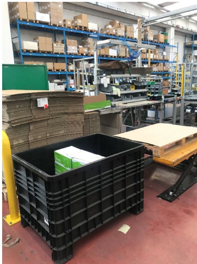
Figura 3.6 La cassa nera in plastica contenente gli accessori KIT; l'operatore conta i componenti per ciascun piano di PF e se li carica nel banco effettuando un nuovo conteggio e picking ridondanti.
