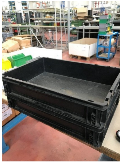
Figura 5.2 Schede nelle cassette D e prove di impilaggio
