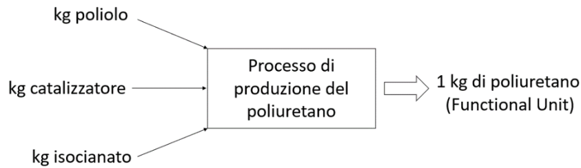
Figura 4.2 – Schematizzazione della fase di inventory analysis per un generico poliuretano
