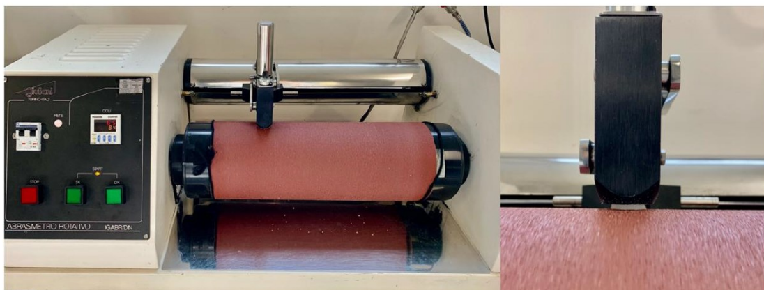
Figura 3.16 – Abrasimetro a tamburo rotativo Giuliani con particolare del portacampione in fase di test
