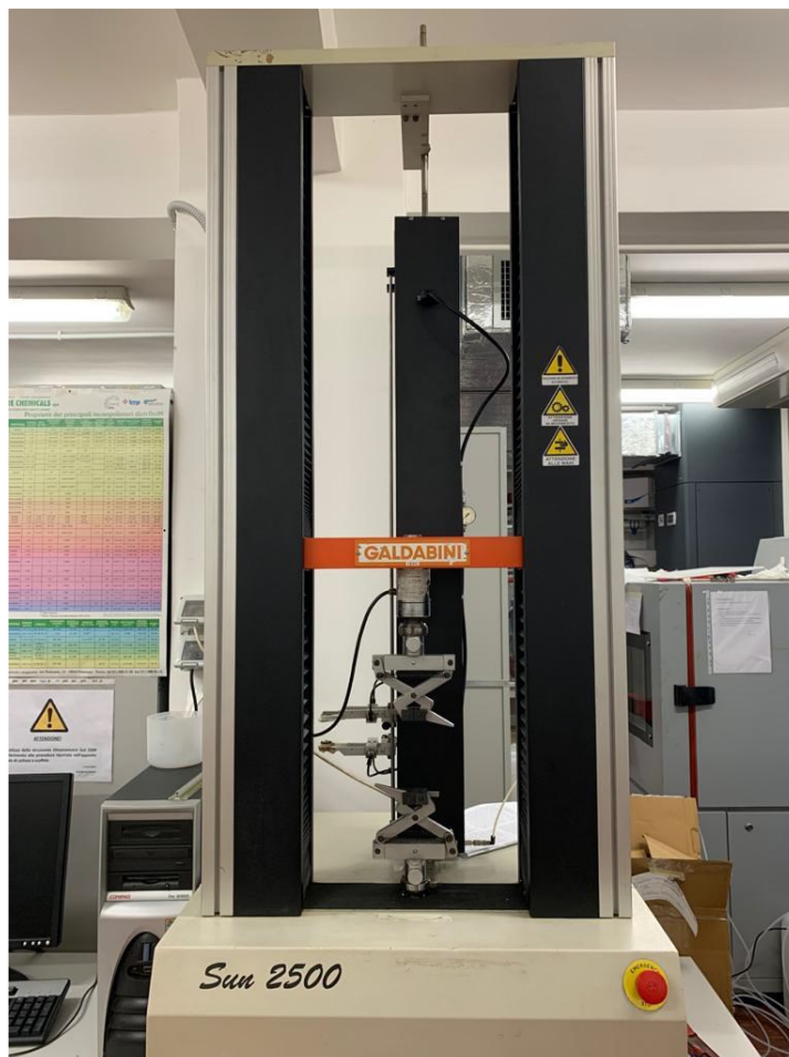
Figura 3.15 – Dinamometro Galdabini Sun 2500 con cella di carico da 25 kN
