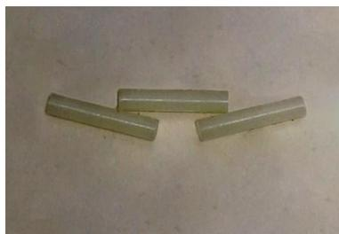
*Figura 4.1: esempio provini ricavati da materozza*
