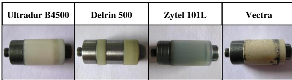
*Figura 5.3: nuclei mobile costampati dopo test di usura 10<sup>6</sup> cicli a 65°C*
