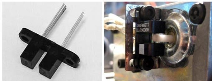
*Figura 4.3: sensore ad infrarossi utilizzato per test di usura, a destra lo stesso montato in valvola*
