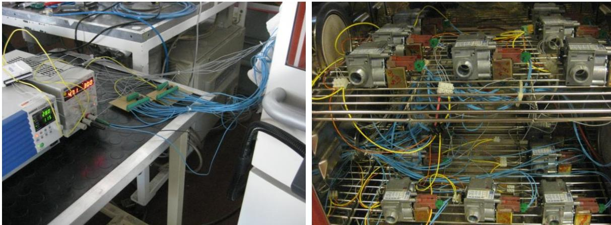
**Figura 4.4:** setting sperimentale per test di usura, a sinistra collegamenti uscenti dalla cella climatica, a destra le 14 valvole all' interno della cella
