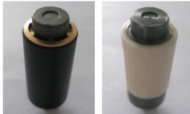
*Figura 1.7: nucleo mobile EV1: a sinistra teflonato con rondella Cu-Be in sommità, a destra costampato simil boccia (rondella sostituita dal polimero)*
