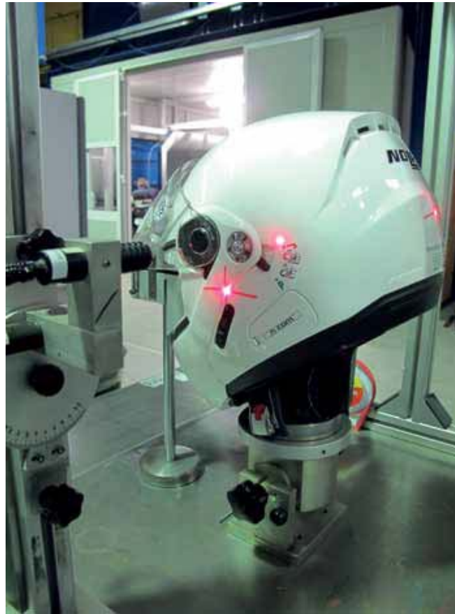
Figura 3.2: Esempio di casco montato su falsatesta per test di omologazione [19]
