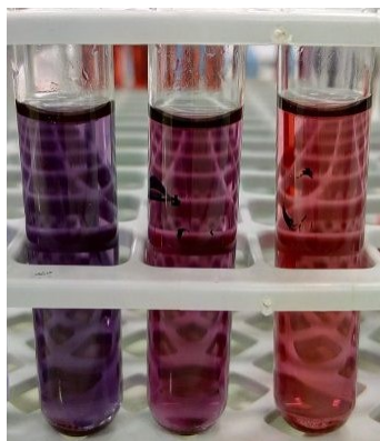
Figura 21. Diversi livelli di aggregazione delle nanoparticelle d'oro portano ad uno shift del colore: la soluzione rossa non è aggregata/poco aggregata; la soluzione viola è aggregata.
