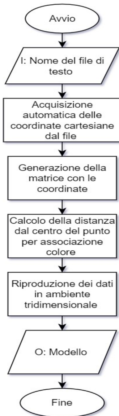
Figura 4.12: Diagramma di flusso della procedura di virtualizzazione
