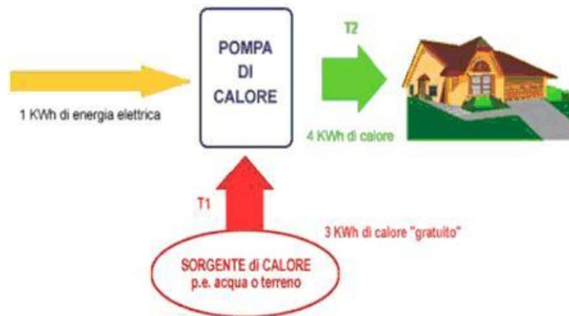
La macchina è in grado quindi di somministrare una quantità di calore  $Q_0$  da una sorgente a bassa temperatura (aria, acqua di falda, lago o terreno) e di trasferirla alla sorgente calda in quantità  $Q_1 = Q_0 + L$  (per esempio l'aria ambiente, l'acqua calda sanitaria o l'acqua del circuito di riscaldamento) a spese di lavoro esterno (energia elettrica per il funzionamento dei compressori).
