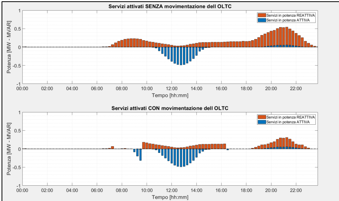
Figura [68] Andamento dei servizi attivati a seguito del processo di ottimizzazione, rispettivamente senza e con possibilità di movimentazione dell'OLTC.
