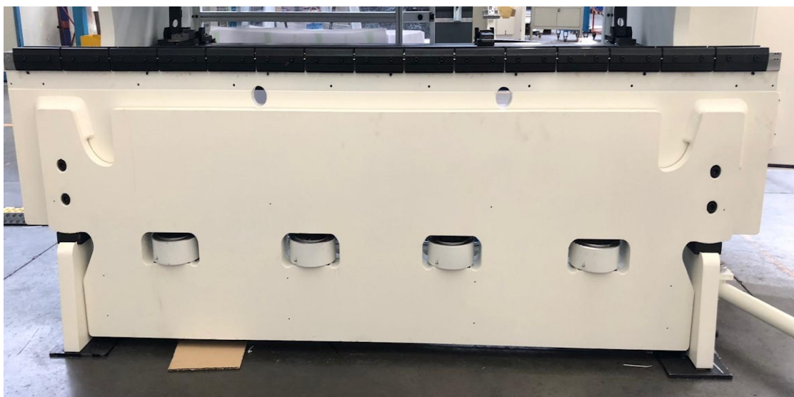
Figura 2. 4: Tavola di una X-Press Gasparini con sistema idraulico di bombatura a 4 pistoni
