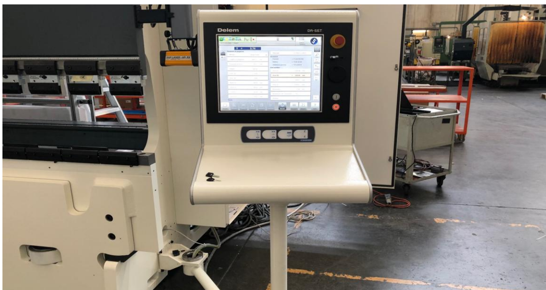
Figura 2. 7: Foto di un sistema di controllo Delem DA-66T di una X-Press Gasparini
