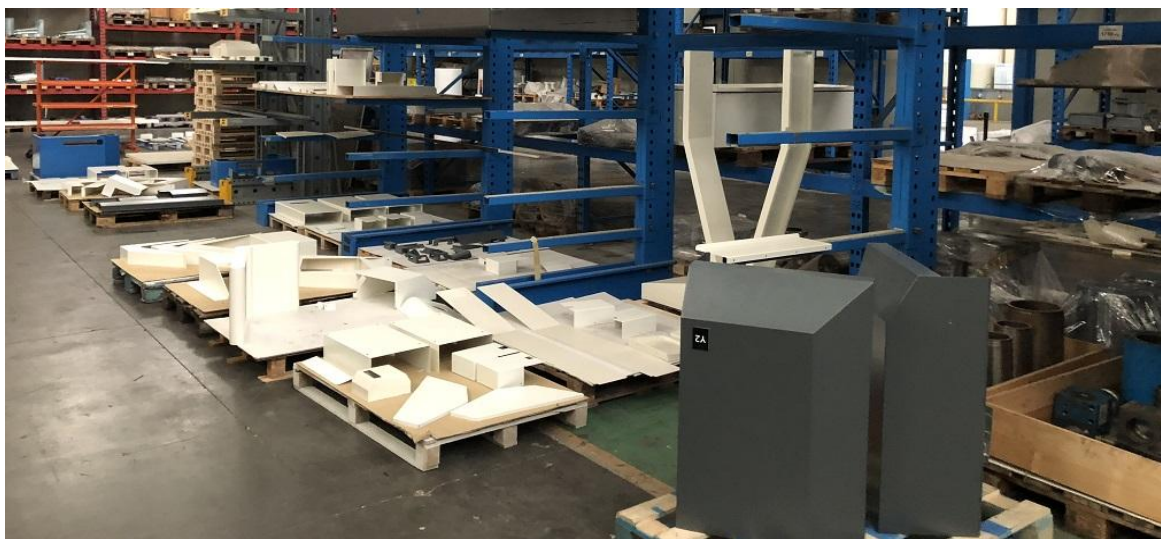
Figura 2. 9: Foto di alcuni componenti di design e carter di una X-Press Gasparini post verniciatura
