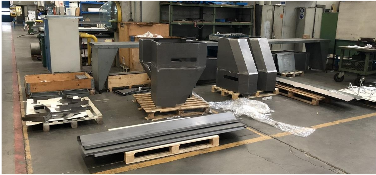
Figura 2. 8: Foto di alcuni pezzi di design e carter di una X-Press Gasparini prima della verniciatura
