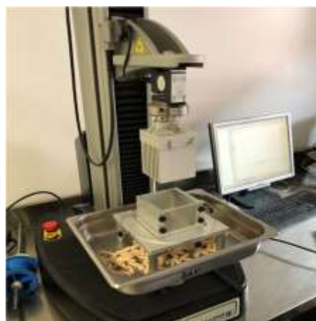
Figura 14b. Valutazione della forza di taglio massima con dinamometro LS5.
