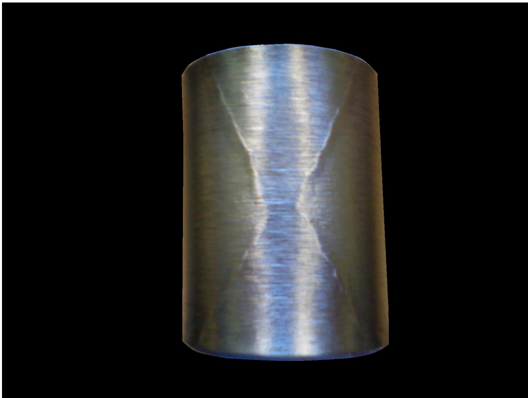
Figura 1.4: particolare di un saggio piegato in cui si possono osservare le linee che dividono la zona di fusione dalla ZTA e quindi dal materiale base.
