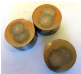
Figura 4.2. I tre campioni analizzati con il quantometro
