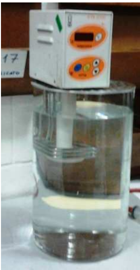
Figura 5.6. Viscosimetro con cui si è analizzato l' aquaquench 352
