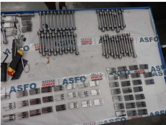
Figura 3.3. Da ciascuno dei 24 barrotti sono stati ottenuti due provini per trazioni e sei per test di resilienza
