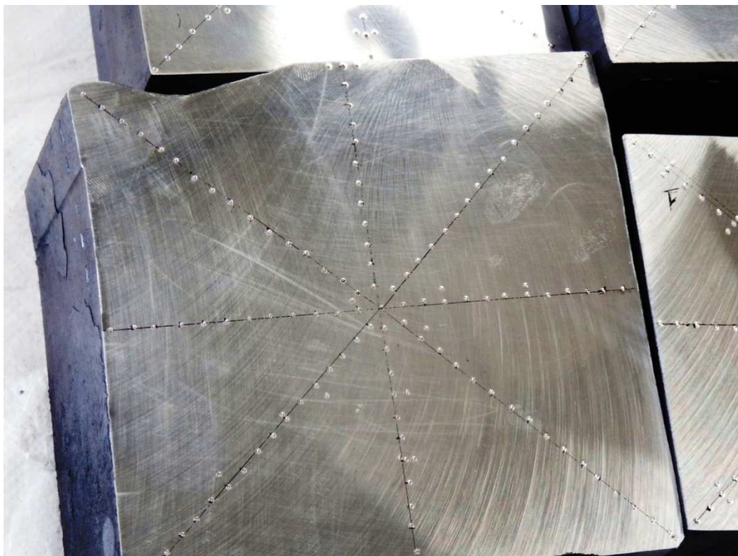
Figura 8.4. Superfici delle sezioni dei simulacri ove sono state eseguite le misure: si notino le impronte delle durezze allineate lungo le mediane e le diagonali
