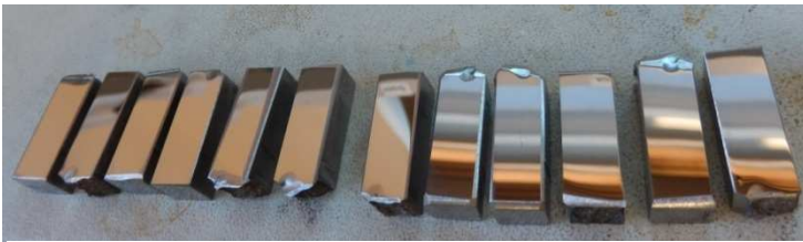
Figura 6.1. Superficie dei campioni lucidata per l'attacco metallografico.
