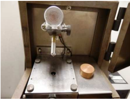
Figura 4.1. Il quantometro con cui si è indagata la composizione. Si noti il contro elettrodo ed il campione di taratura
