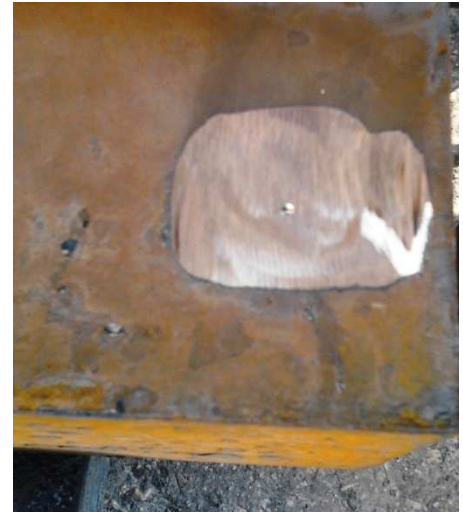
Figura 7.2. Esempio dell'impronta lasciata dalla sfera Brinell sulla superficie abrasa di un simulacro
