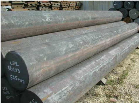
Figura1.2. Lingotti cilindrici ottenuti per colata continua
