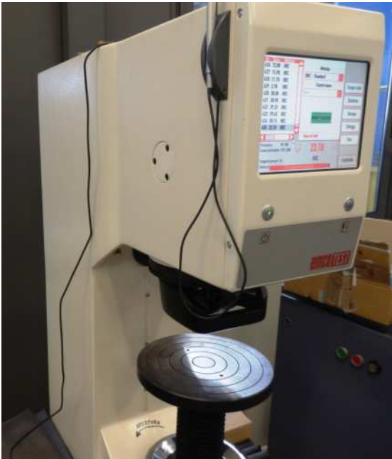
Figura 8.3. Durometro Rockwell con cui sono state eseguite le misure
