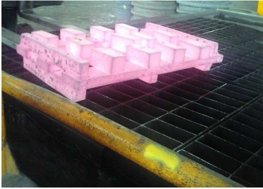
Figura 5.2. 12 simulacri roventi pochi istanti prima di essere spenti in acqua.
