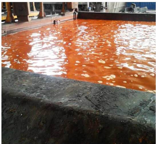
Figura 4.4. Vasca contenente la soluzione polimerica di aquaquench 352
