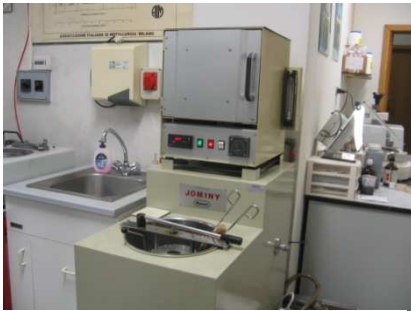
Figura 8.6. Apparecchio della "Remet" utilizzato per la prova della temprabilità Jominy
