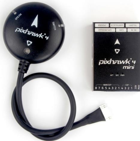
Figura 5: Foto della Pixhawk 4 mini (a destra) e del relativo modulo GPS (a sinistra)
