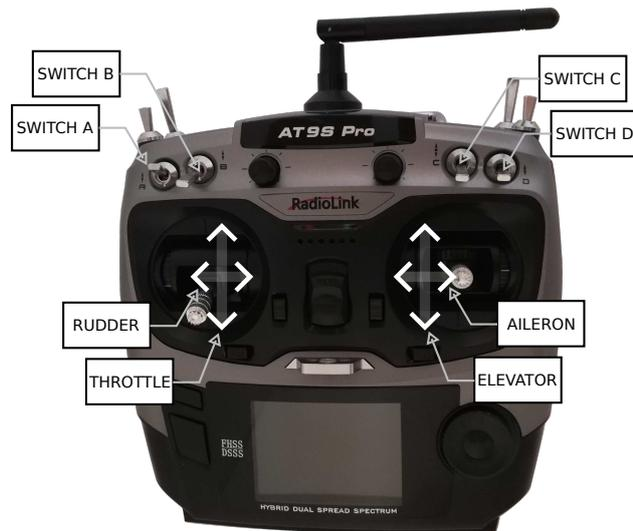
Figura 9: Foto del radiocomando RadioLink T9S Pro e specifica dei comandi più importanti
