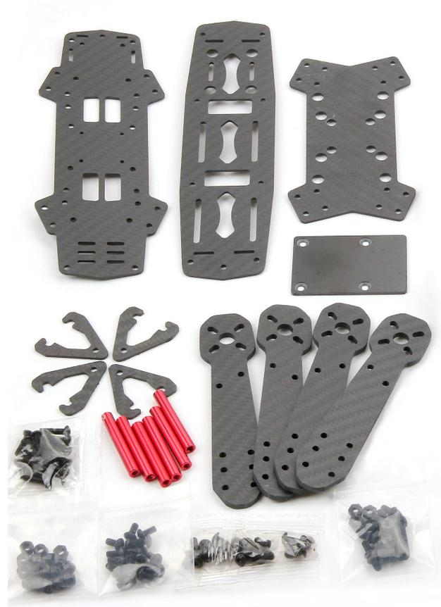
Figura 1: Foto dei pezzi della struttura presenti nel kit
