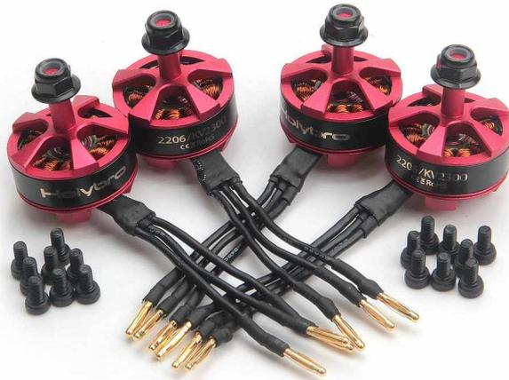
Figura 6: Foto dei 4 motori brushless HolyBro 2206/KV2300 con relativa bulloneria per il fissaggio
