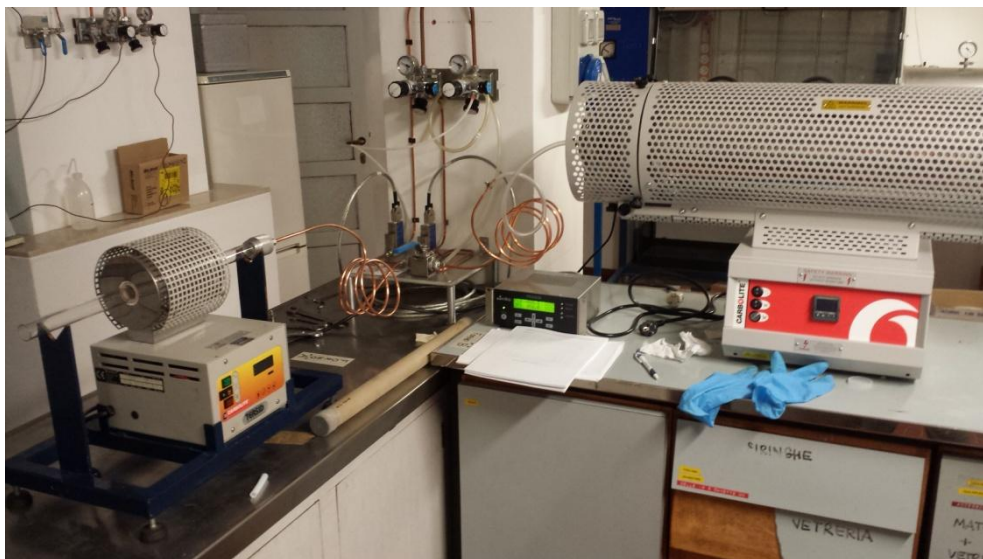
FIGURA 2.15- Sulla sinistra la fornace tubolare Carbolite utilizzata per la sintesi.
