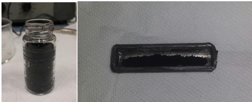
FIGURA 3.03 - (a) Fiala di omogeneizzazione, (b) navetta in quarzo per il trattamento termico.
