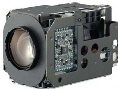
Figura 52: Videocamera dell'Ulisse Compact: Sony FCB-EX480CP
