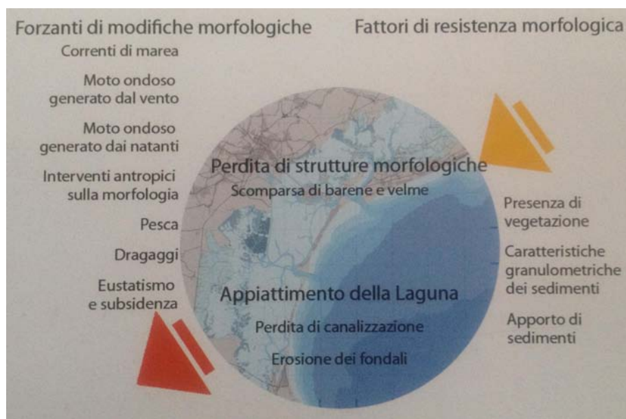
Figura 3.1: Schema con le forzanti di modifiche e fattori di resistenza morfologica operanti in Laguna di Venezia
