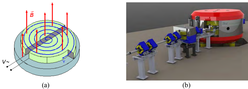
Figura 1.5. Ciclotrone per il progetto SPES: a) schema, e b) ciclotrone Best 70p
