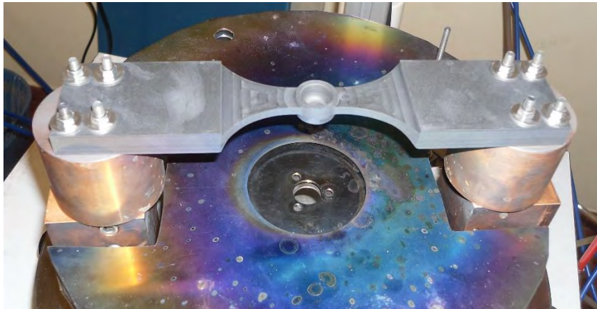
Figura 6.11. Crogiolo della cella di Knudsen progettata a LNL montato sul forno pre-esistente
