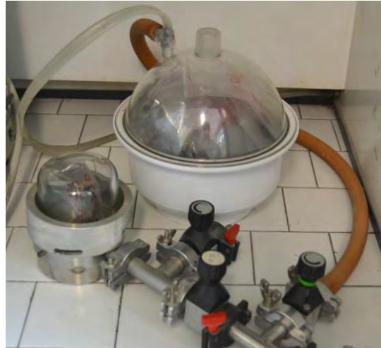
Figura 4.23. Essiccatori impiegati per la conservazione dei campioni e tubi di collegamento con la pompa rotativa
