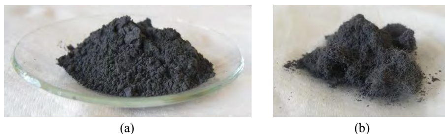
Figura 4.4. Miscela ottenute dopo (a) il primo stadio della macinazione (miscela per blank) e (b) il secondo stadio della macinazione per un campione NY 4.0 10 %
