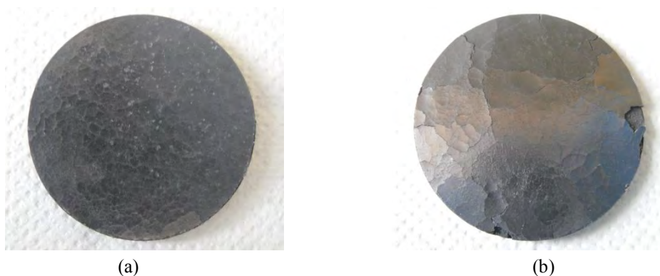
Figura 4.12. Dischi ottenuti dopo il primo trattamento con composizione: a) NY 2.0 mm 8 % e b) PP 3.2 mm 10 %
