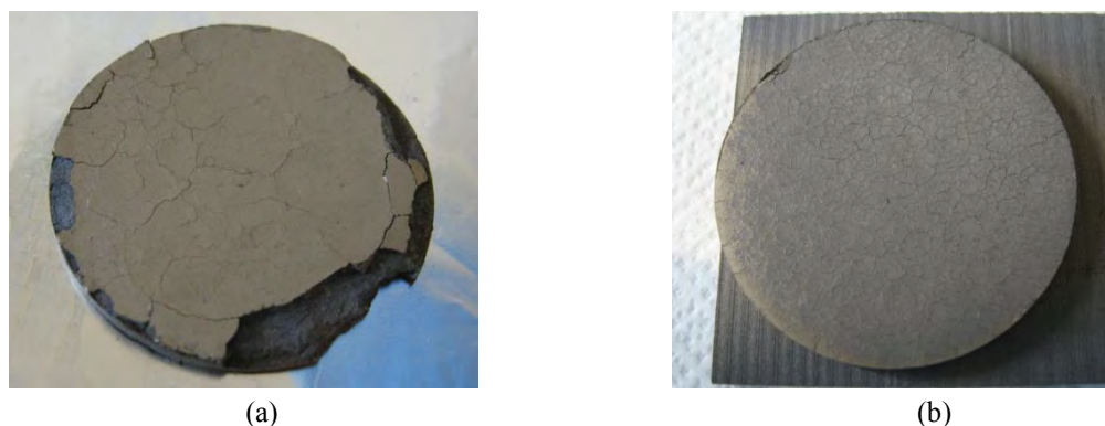
Figura 4.16. Dischi ottenuti dopo il secondo trattamento con composizione: a) PP 3.2 mm 4 % e b) PP 1.6 mm 6 %
