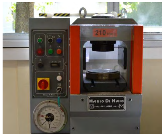
Figura 4.5. Pressa idraulica della ditta Mario di Maio impiegata per la produzione dei dischi
