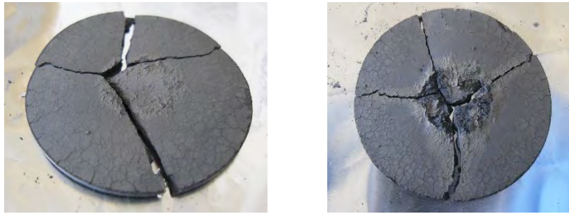
Figura 5.39. Campioni PP 1.6 mm 4 % rotti in corrispondenza dell'area centrale danneggiata
