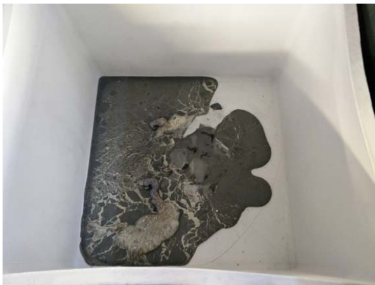
Figura 6.37: Silicio fuso e solidificato al termine del test
