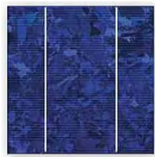
Figura 3.3: Cella in Silicio policristallino
