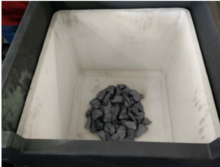
Figura 6.36: Silicio inserito nel crogiolo per il test
