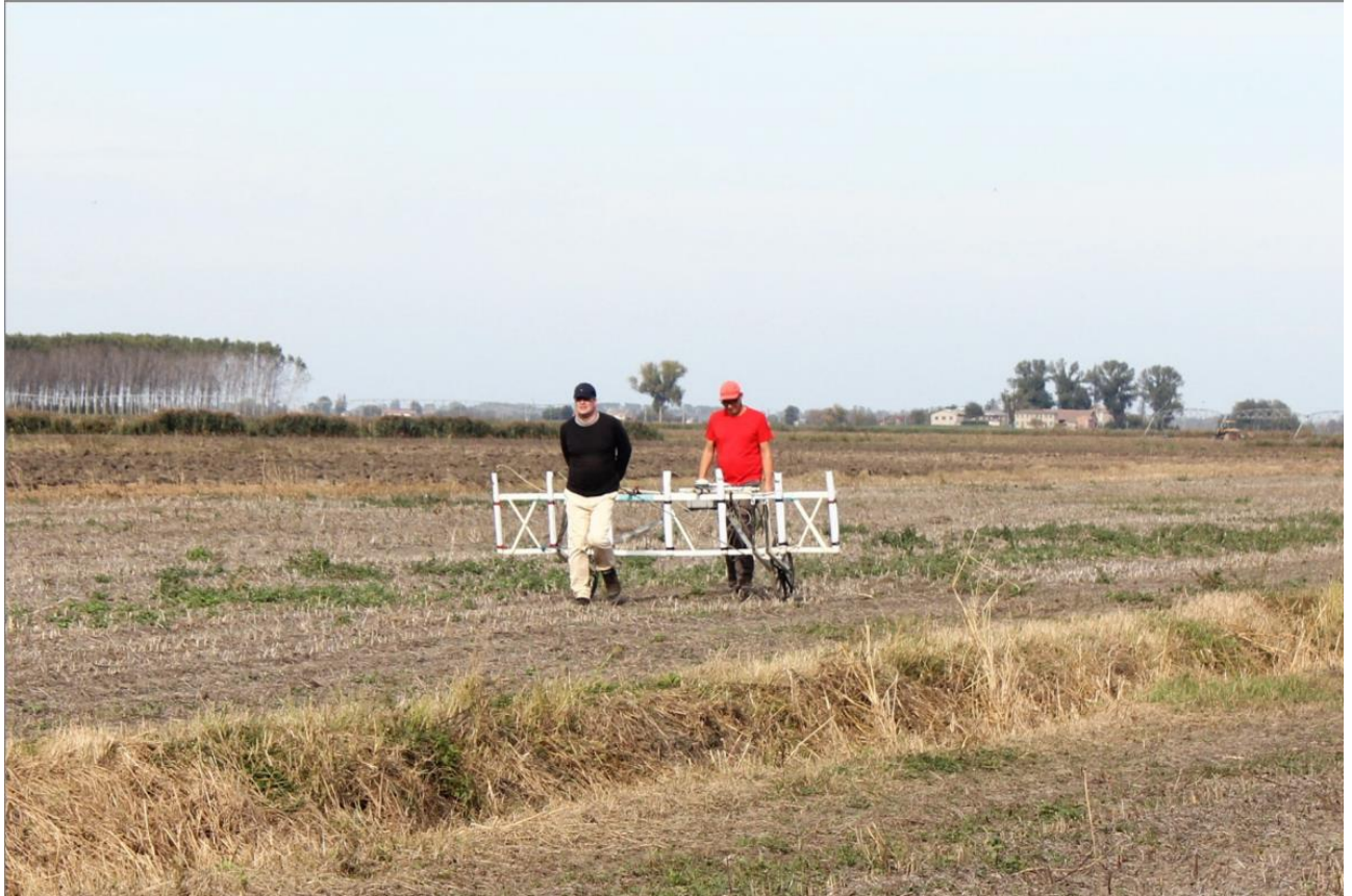
Figura 60 Immagine di una fase di lavoro durante le acquisizioni con il sistema gradiometrico fluxgate con 7 sensori di Cornelius Meyer (da MEYER 2021, p. 8).
