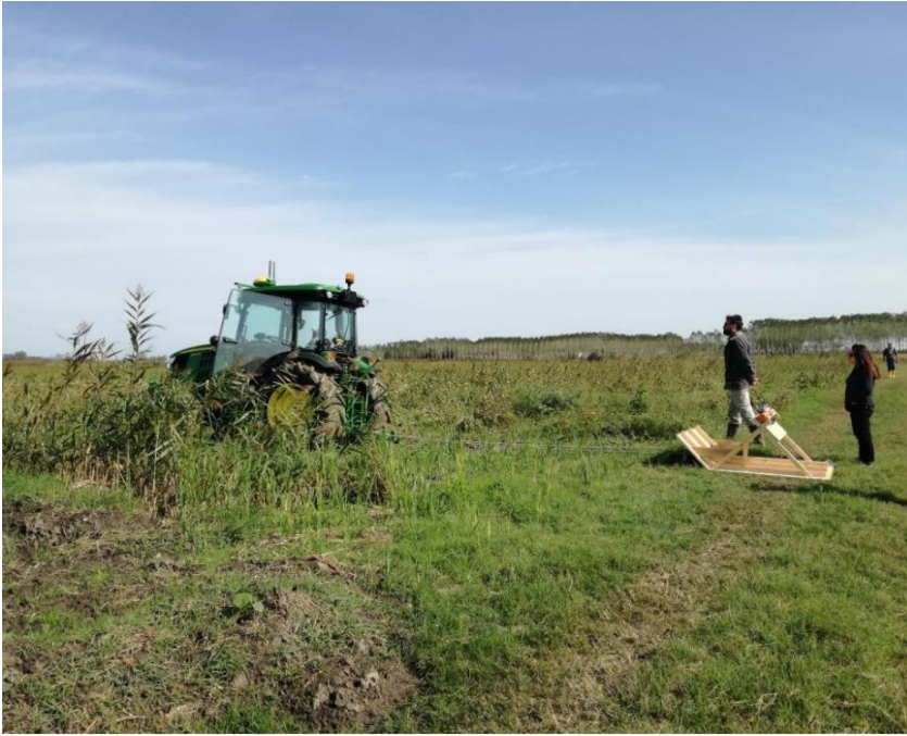
Figura 55 Immagine del sistema di acquisizione dei dati FDEM con slitta durante una fase di lavoro.
