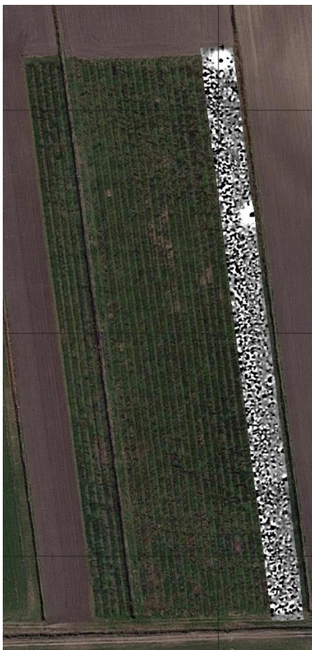
Figura 10 Cfr. infra, fig. 61. Esempio di dato magnetico affetto da disturbi legati alla presenza di materiale ferroso legato all'utilizzo recente del suolo: mappa del gradiente magnetico tratta dalla relazione di C. Meyer relativa alle prospezioni magnetiche in un'area del sito di San Basilio affetta da disturbo ferromagnetico molto elevato (da MEYER 2021, mappa 2012-101 modificata).
