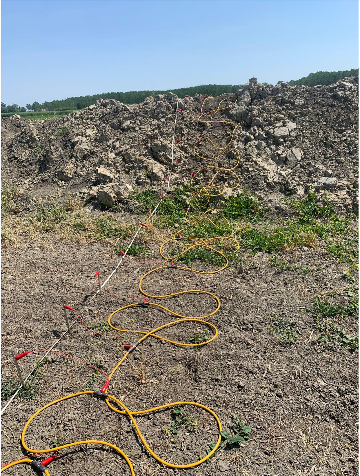
Figura 64 Immagine della linea ERT a cavallo del saggio di scavo 2021. Da notare la difficoltà di rilevamento dovuta alla presenza delle masse di terra ai lati del saggio di scavo.
