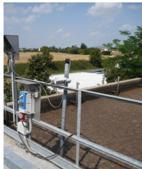
Fig. 3.5: sonda per la misura di ossigeno.
