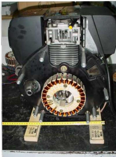
Figura 1.5: Motore Brushless sinusoidale con rotore esterno.
