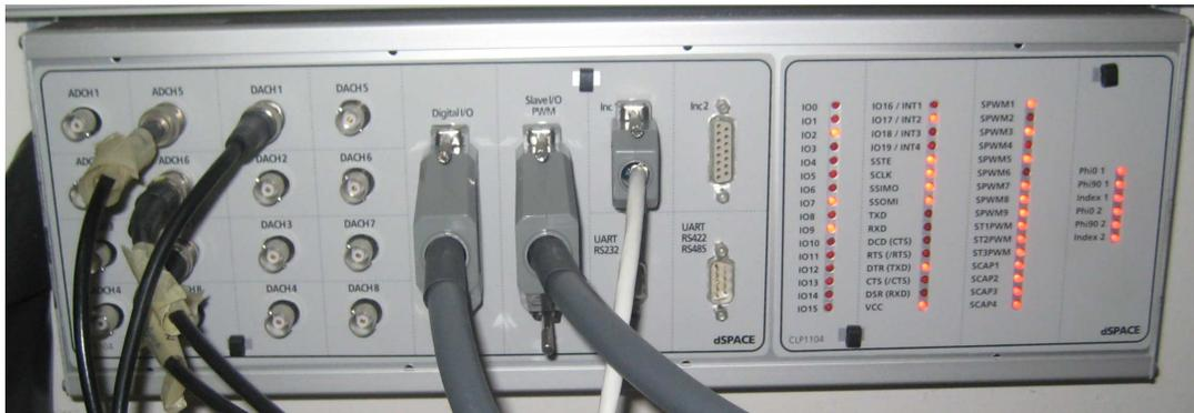
Figura 1.9: Scheda di acquisizione dSpace.
