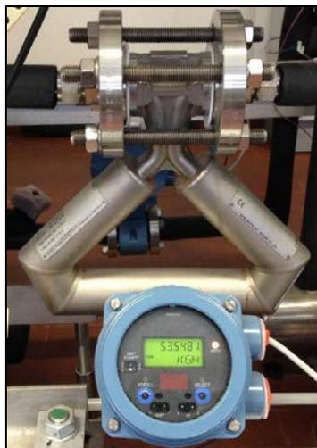
**Figura 3.8** – Foto del misuratore di portata di massa ad effetto di Coriolis
