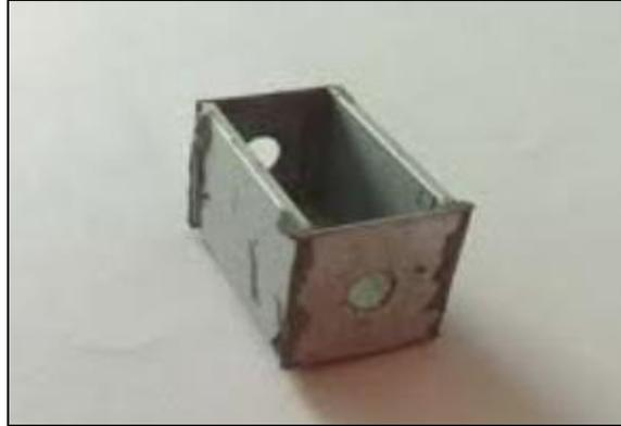
**Figura 2.12** – Profilato di alluminio con le due lamine forate all'estremità all'interno del quale viene collocata la sezione sperimentale
