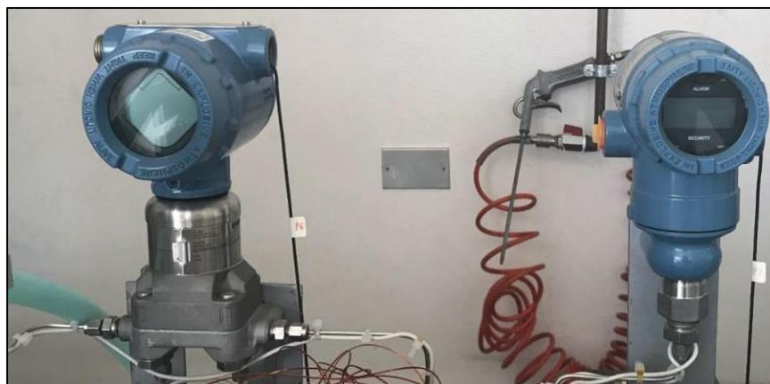
**Figura 3.10** – A sinistra si vede il misuratore di pressione differenziale identificabile dalla presenza di due uscite, a destra è riportato il misuratore di pressione assoluta. Si noti il dettaglio delle resistenze elettriche (filamenti bianchi) che servono per riscaldare i tubicini connettori impedendo la condensazione del fluido. [42]
