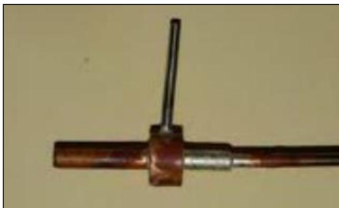
**Figura 2.13** – Dettaglio della presa di pressione [41]
