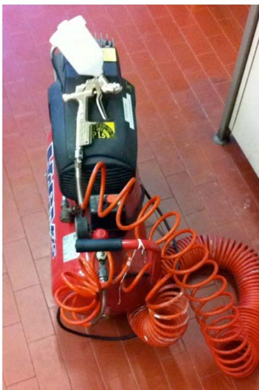
**Fig. 7.5** Strumento utilizzato per la deposizione delle soluzioni. In figura è presente l'aerografo con il serbatoio collegato al compressore.
