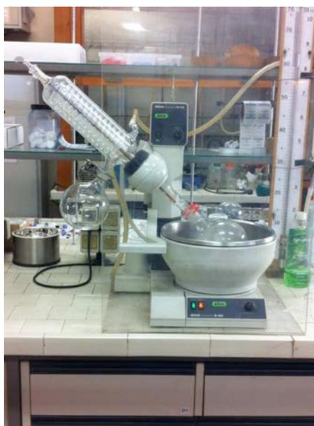
**Fig. 3.13** Buchi Rotavapor R-114 in funzione presso i laboratori del Dipartimento di Ingegneria Industriale dell'Università degli Studi di Padova.
