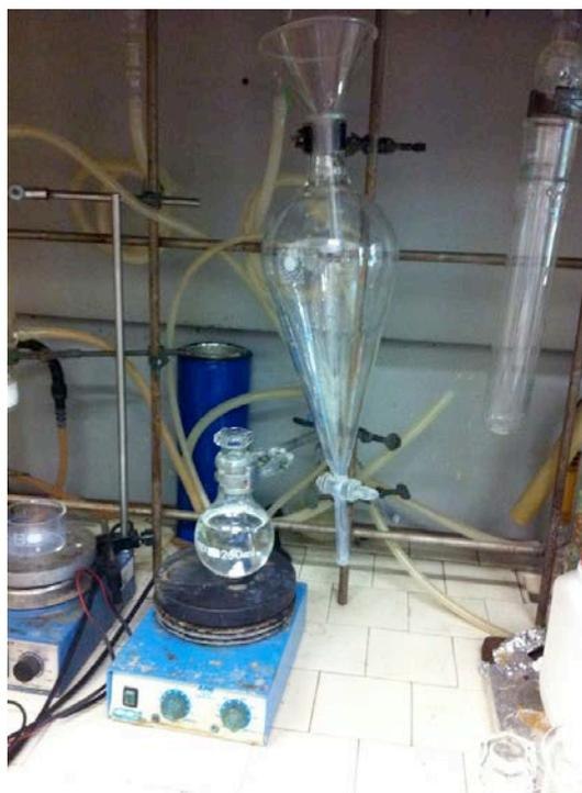
**Fig. 3.12** In figura si può notare a sinistra il pallone in cui viene svolto il mixing delle due fasi e a destra l'imbuto separatore per la separazione delle stesse.
