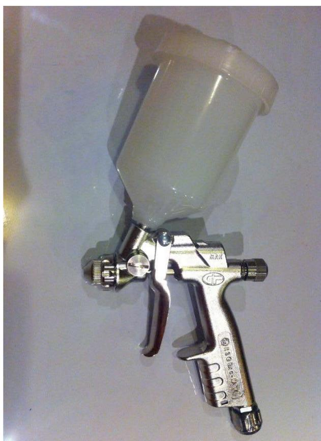
**Fig. 3.9** Aerografo modello GF Ø1.0 – 11/A. Si può notare il serbatoio a caduta da 250 ml, la pistola di verniciatura in alluminio e cromo. A sinistra è presente l'ugello di uscita e a destra la rotella per la regolazione dell'ampiezza del getto.
