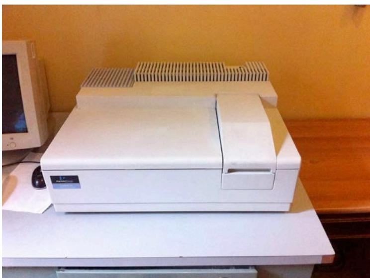
**Fig. 3.7** *Spettrofotometro Perkin-Elmer Lambda 25 presente presso i laboratori del Dipartimento di Ingegneria Industriale dell'Università degli Studi di Padova.*
