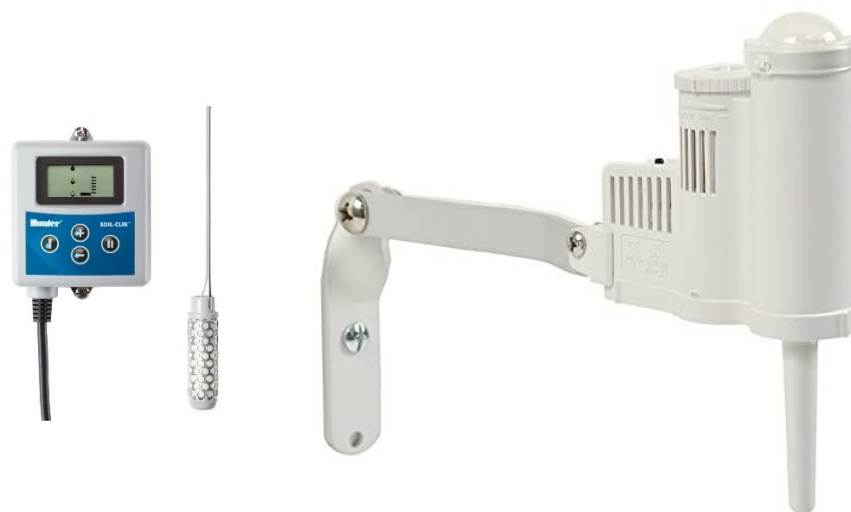
Immagine 1 Sensore per il rilevamento dell'umidità Soil-Click (sulla sinistra), che utilizzano sensori per misurare l'umidità del terreno, e Solar Sync (sulla destra), che si basano su un sistema di calcolo dell'ET tenendo conto delle condizioni climatiche della giornata.
