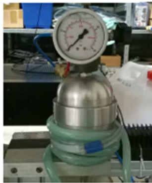
Fig. 3 Vaso di espansione
