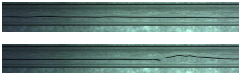
Fig. 43 Regime di deflusso visualizzato con G=50 \text{ kg}/(\text{m}^2 \text{ s}) e x=0.45
